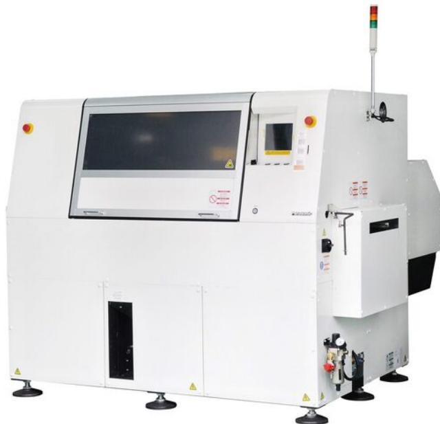
**O pequeno e eficiente AV132 tem um desempenho de 30.000 cph. Devido às características de destaque, o AV132 é uma máquina de inserção THT axial de alta velocidade.**
