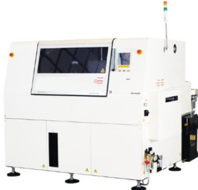
**A máquina radial de inserção THT de alta velocidade RL132, com um tempo de ciclo de 0,14 s/componente, oferece excelente tecnologia em uma área eficiente.**
