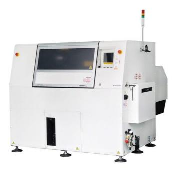
O pequeno e eficiente AV132 tem um desempenho de 30.000 cph. Devido às características de destaque, o AV132 é uma máquina de inserção THT axial de alta velocidade.
