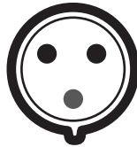
2P/3W 32 A 250 V Position d'horloge à 6h
